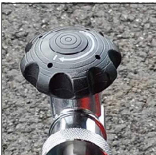
Vanne de bouteille sans dispositif de protection antifuite
